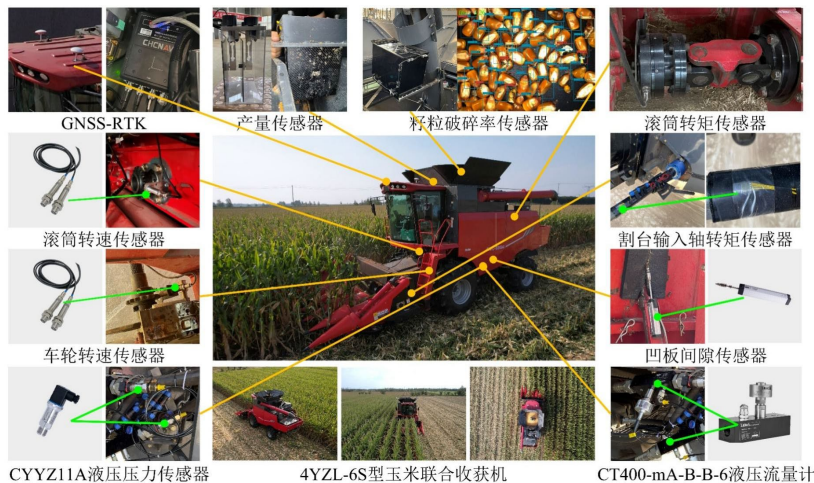
图A-2 大型玉米联合收获机物理实体开发
