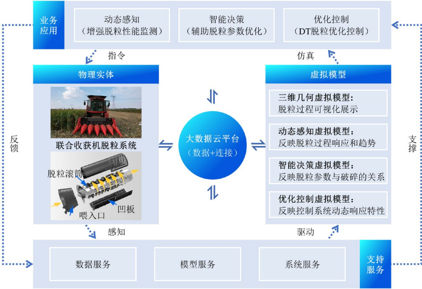
图A-1 面向脱粒的大型联合收获机数字孪生系统框架
